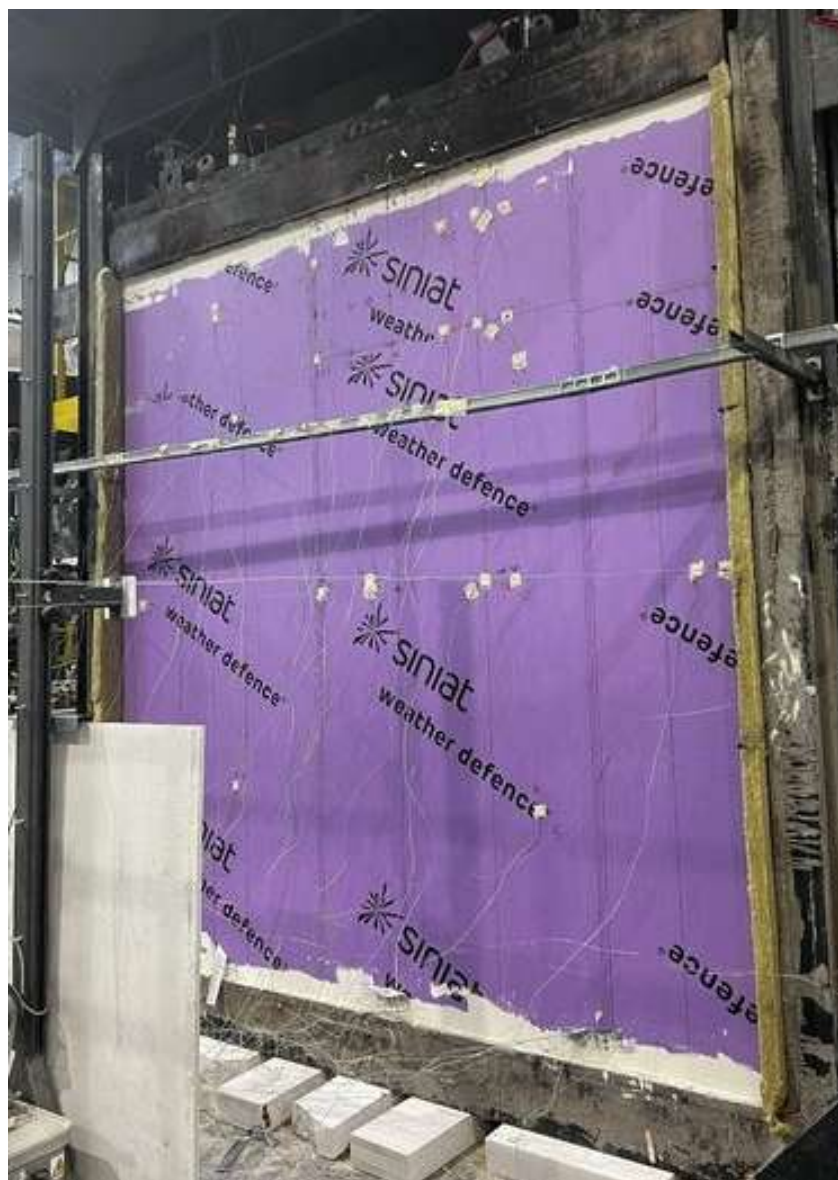
Figuur 1: Brandproef 24889A-rev1 (brand langs binnen), Warringtonfire Gent
