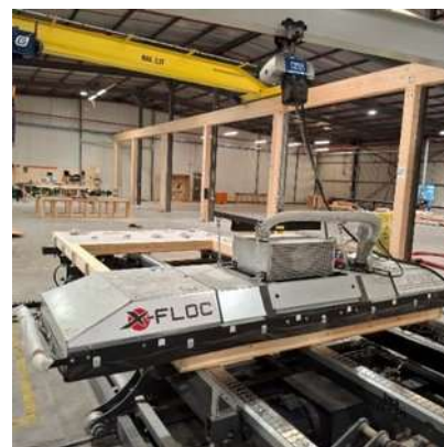
Figuur 9: Inblazen in productie met de EP800 inblaasplaat.
