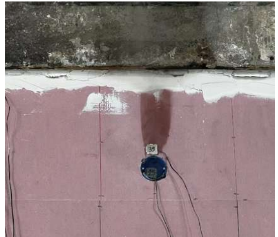
Figuur 3: Onbeschermd inbouwdoos in de iQ3 cellulose isolatie, brandproef 24817A (brand langs buiten), Warringtonfire Gent
