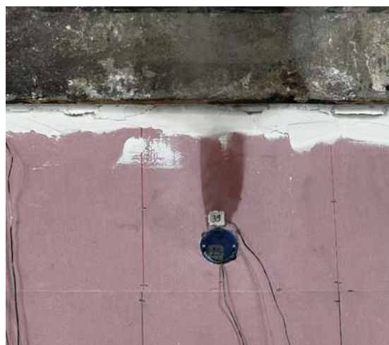
Illustration 3 : Boîte d'encastrement non protégée dans l'isolation en cellulose iQ3 pendant l'essai 24817A REI 60 iQ3 Warringtonfire Gand
