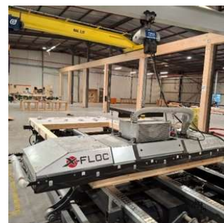
Illustration 9 : Insufflation en production avec la plaque d'insufflation EP800.
