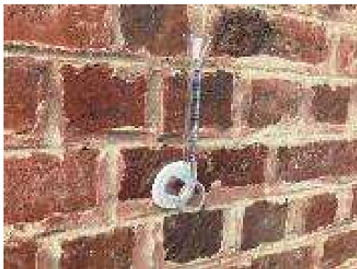
Mesure de l'absorption d'eau à l'aide d'une pipe de Karsten. Source : CSTC - NIT 224 Hydrofugation de surface, juin 2002.
