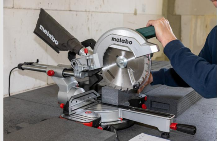
Outil recommandé : scie de coupe avec lame de coupe longitudinale à grosses dents (p. ex. lame HW blaugelb 250x3,2/2,2x30 mm Z24 W, réf. 0399564).
